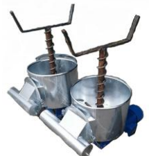
Annahmekasten mit Rührwerk
